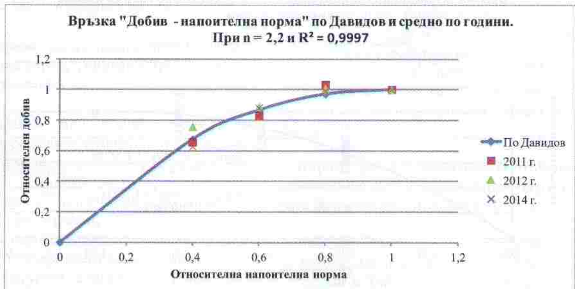
Фиг. 4 Зависимост „добив напоителна норма”, определена по степенната формула на Давидов y=1-(1-x)^n за трите години на опита.
